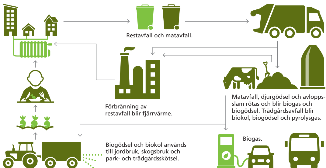
Figur 24. Kretslopp för samband och synergieffekter mellan olika tekniska försörjningssystem och anläggningar
